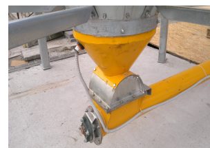
Regulowana stacja przesypowa – umożliwia regulację kąta pracy podajnika
