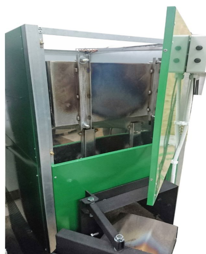
Łatwy dostęp do komory spalania i wymiennika ciepła
