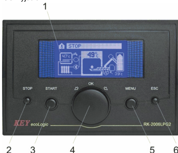
Rysunek 1. Płyta czołowa regulatora RK-2006LPG2.
