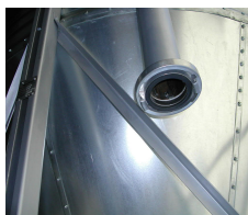
Złącze DN 110 do załadunku pneumatycznego
