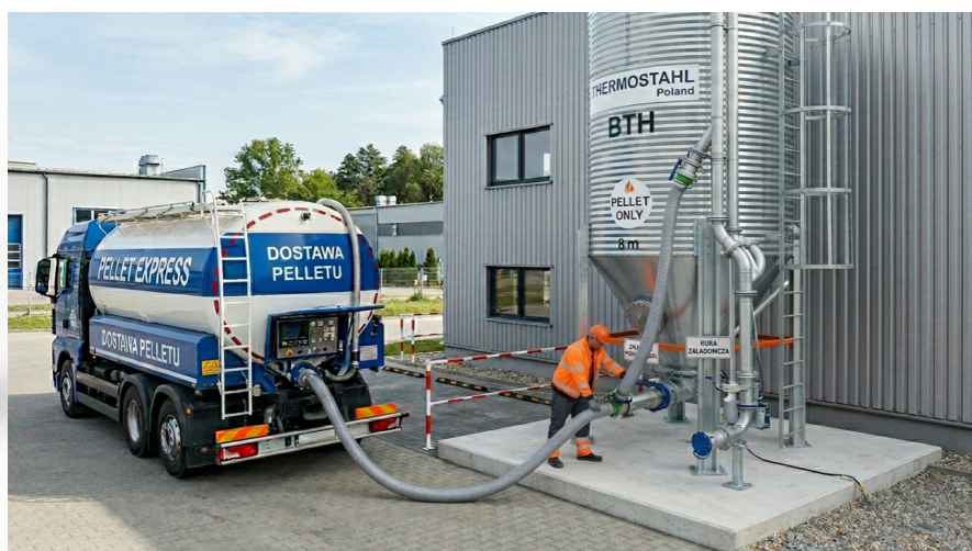
Załadunek pneumatyczny pelletu silosa z cysterny
